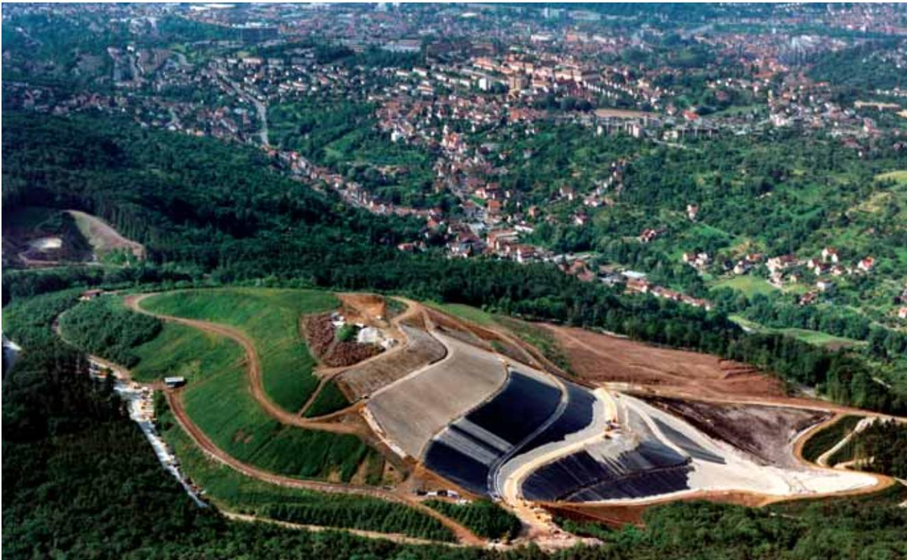
*Luftbild aus dem Jahr 1991 mit Bau von Erweiterungabschnitt 1 und Kunststoffabdichtung zum bestehenden Deponiekörper.*
